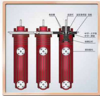
动密封技术：创新的动密封结构设计保障用于充气柜断路器可靠运行。
